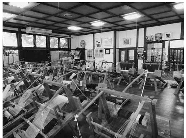
写真1 佐渡市技能伝承展示館で使用されている復元されたねまり機
