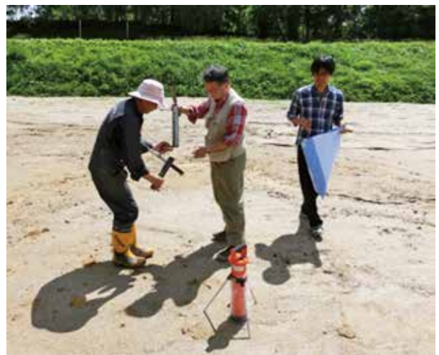
図 1-6 土壌サンプラーによる採取
