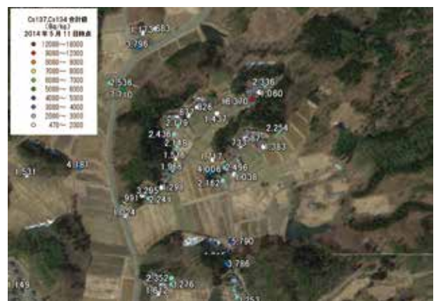
図 3-6 2015年4月26日計測結果, 2013年と比べてCsの濃度は下がっている
