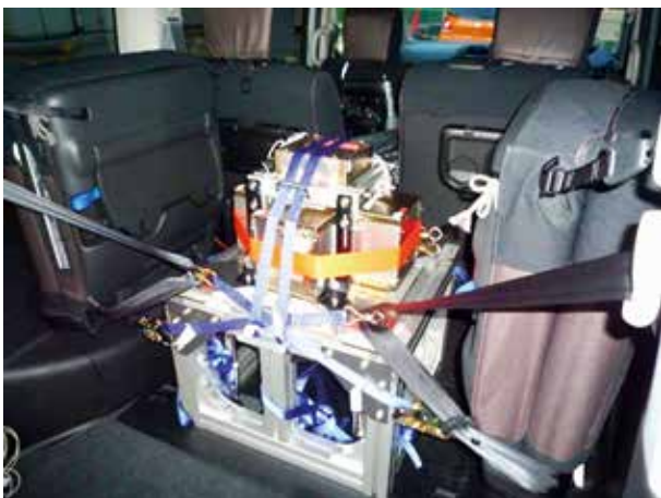
図 2-2 自動車の荷台に搭載したASURA。6台の鉛遮蔽体付き検出器で構成され、自動車の進行方向に対して前後左右及び上下の6方向に分けて、それぞれの方向から入射したガンマ線の量を測定することが出来る
