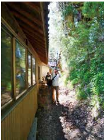
図 2-1 BISHAMON歩行サーベイの様子。測位精度向上のためGPSのアンテナを高く上げている
