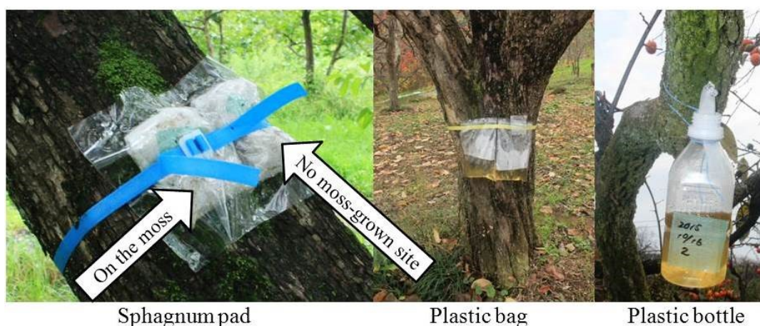
図 6.14 幹流水捕集装置の設置状況（伊達市柱沢・無洗浄樹）
